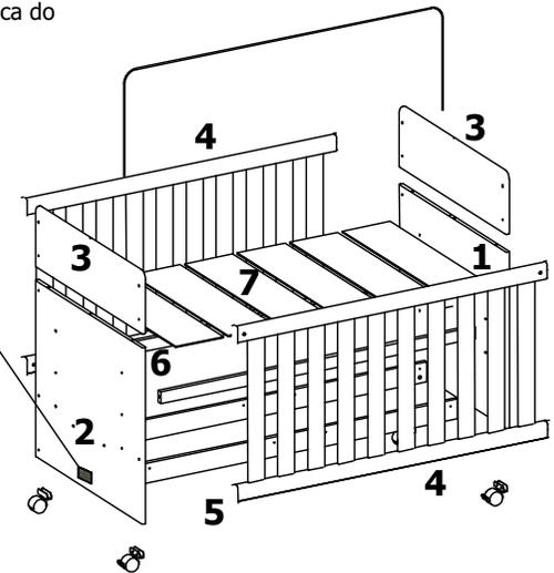
Nota: Recomendamos o uso de ferramentas manuais conforme o quadro na vista de frente. Porém no caso de uso de parafusadeira, iniciar a montagem dos parafusos com o torque na escala mínima para evitar de espanar a rosca. Aumentar o torque gradativamente, se necessário.
