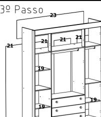
Nota: Recomendamos o uso de ferramentas manuais conforme o quadro na vista de frente. Porem no caso do uso de parafusadeira. iniciar a montagem dos parafusos com torque na escala mínima para evitar de espanar a rosca. Aumentar o torque gradativamente se necessário
