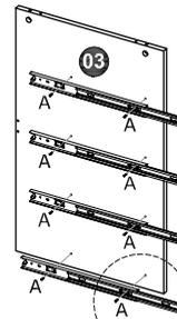
• Fixar a parte externa das corrediças telescópicas na Lateral esquerda (02) e na Lateral direita (03) com parafusos 3,5 x 12mm (A).
