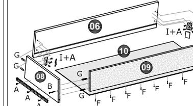
• Fixar Pannel traseiro da gaveta (09) nas Laterais (07) e (08) com cavilhas (G), cola e parafusos 3,5 x 40mm (B).
