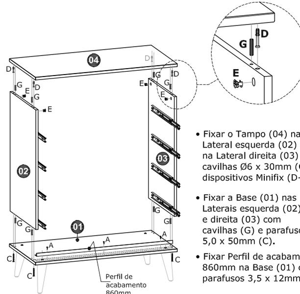
• Fixar o Tampo (04) na Lateral esquerda (02) e na Lateral direita (03) com cavilhas Ø6 x 30mm (G) e dispositivos Minifix (D+E).
