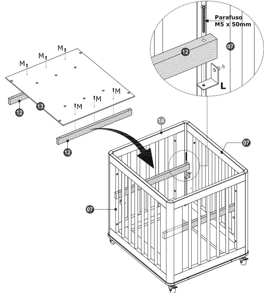
**IMPORTANTE!** O estrado, formado pelos Sarrafos (12) e pela Placa (13) fixados entre si por parafusos 3,5 x 22mm (M), não deve ser mais desmontado para transporte ou para armazenamento do berço. Havendo necessidade de reposicioná-lo ou retirá-lo do berço, basta remover os parafusos M5 x 50mm utilizados para fixar os sarrafos (12) nos suportes (L).
