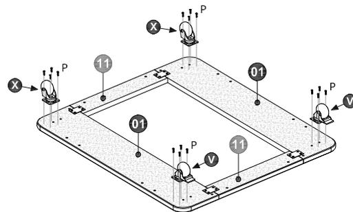
**IMPORTANTE!** Uma vez aplicados, os parafusos 3,5 x 16mm (P) não devem ser mais removidos para desmontagem, transporte ou armazenamento.
