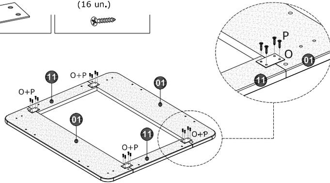
**IMPORTANTE!** Uma vez aplicados, os parafusos 3,5 x 16mm (P) não devem ser mais removidos para desmontagem, transporte ou armazenamento.
