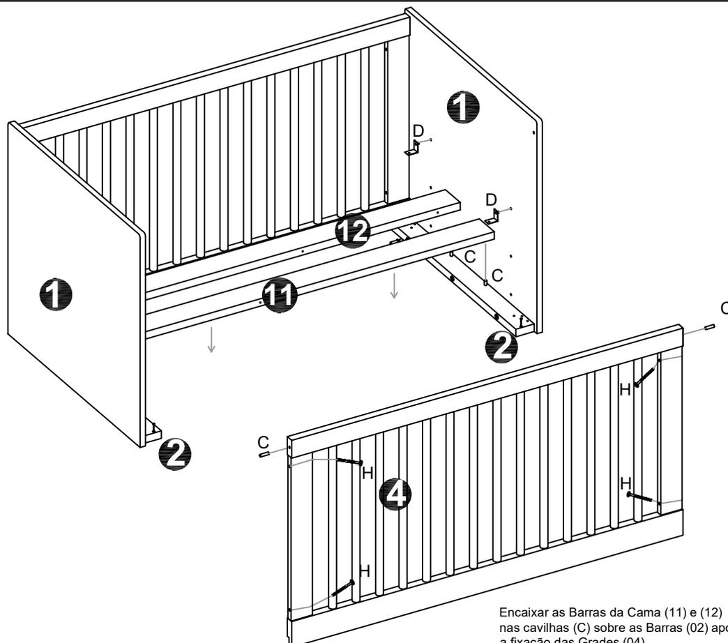
Encaixar as Barras da Cama (11) e (12) nas cavilhas (C) sobre as Barras (02) após a fixação das Grades (04).
