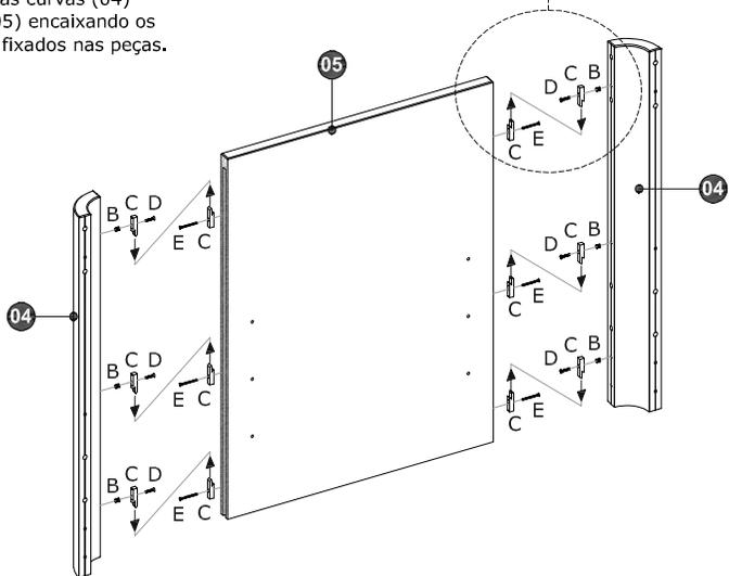
**!** Repetir os procedimentos deste 5.º PASSO para ambos os conjuntos de Colunas curvas (04) e Cabeceiras (05).
