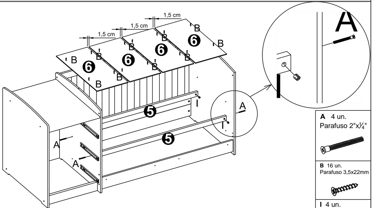
NOTA: Estrado formado por Placas (6) e Sarrafos (5) não deve ser desmontado para transporte ou armazenamento
